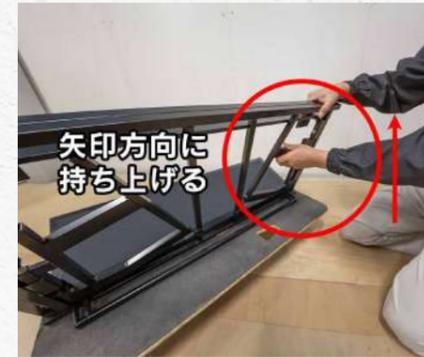
⑭ バックフレームを矢印方向に持ち上げて展開(転倒防止脚と同じ要領)
