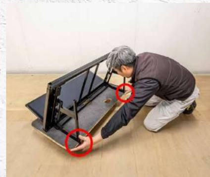
⑲ 組立後、印の箇所を台車に引っ掛けて最後まで押し込む
