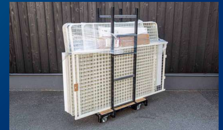
⑧ 横挿し上枠あり：板物+上段にも積載可能
